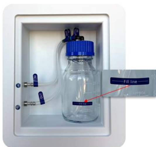
Figur 21.1 Slanganslutning på befuktningsflaskan och Multi-zone ART-arbetsstationen
